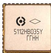
Рисунок 2. Внешний вид микросхемы 5112НВ035
