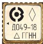
Рисунок 2. Внешний вид микросхемы 5400TP045A-049-18
