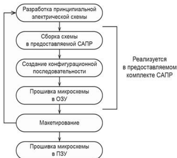
Рисунок 3. Маршрут проектирования программируемых схем
