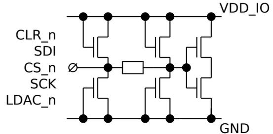
Рисунок 9. Цифровые входы сигналов управления
