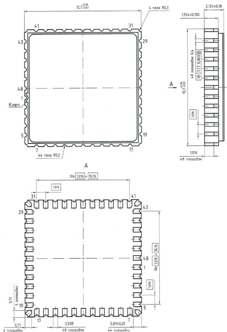
Рисунок 12. Габаритный чертёж корпуса 5142.48-A (размеры в мм)
