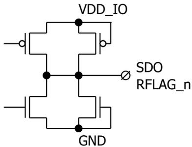
Рисунок 8. Цифровые выходы сигналов управления
