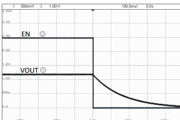
Рисунок 12. Выходное напряжение при переключении EN из «1» в «0» ( $V_{IN} = 5,0 \text{ В}$ )
