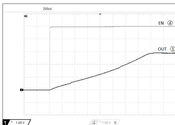
Рисунок 10. Выходное напряжение при переключении EN из «0» в «1»
