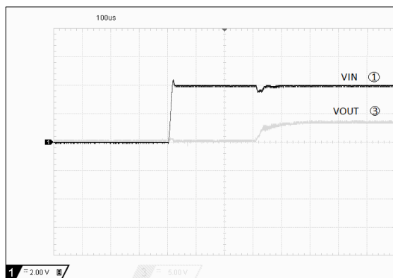
Рисунок 43. Изменение выходного напряжения при подаче входного напряжения ( V_{IN} = 4,0 \text{ В} , V_{OUT} = 3,3 \text{ В} , I_{LOAD} = 1,0 \text{ мА} )
