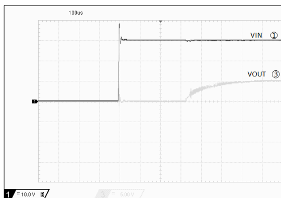
Рисунок 25. Изменение выходного напряжения при подаче входного напряжения ( V_{IN} = 30\text{ В} , V_{OUT} = 5,0\text{ В} , I_{LOAD} = 1,0\text{ мА} )
