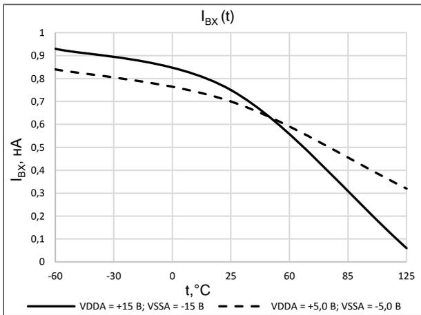
Рисунок 3. Зависимость входного тока сигналов управления от температуры
