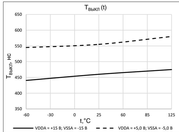
Рисунок 10. Зависимость времени выключения от температуры
