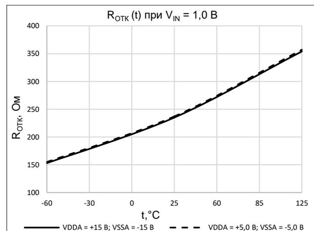
Рисунок 6. Зависимость сопротивления открытого ключа от температуры
