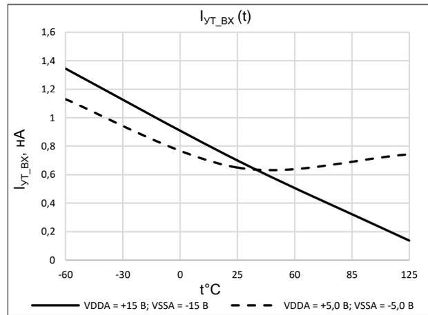
Рисунок 4. Зависимость входного тока утечки от температуры
