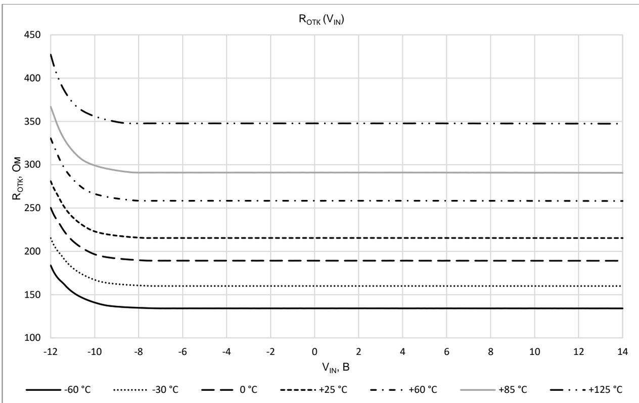
Рисунок 11. Зависимость сопротивления открытого ключа от коммутируемого напряжения при различных значениях температуры при VDDA = +15 В, VSSA = -15 В
