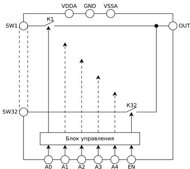
Рисунок 1. Структурная схема
