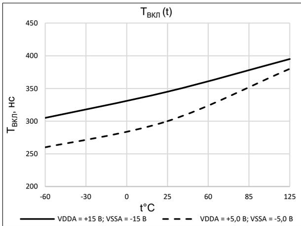
Рисунок 9. Зависимость времени включения от температуры
