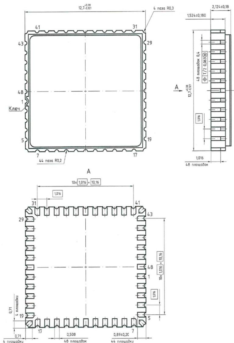
Рисунок 13. Габаритный чертёж корпуса 5142.48-A (размеры в мм)
