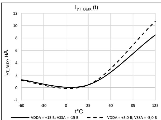
Рисунок 5. Зависимость выходного тока утечки от температуры
