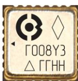
Рисунок 2. Внешний вид микросхемы 5400TP055A-008(3)
