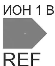
Рисунок 12. Источник опорного напряжения.
