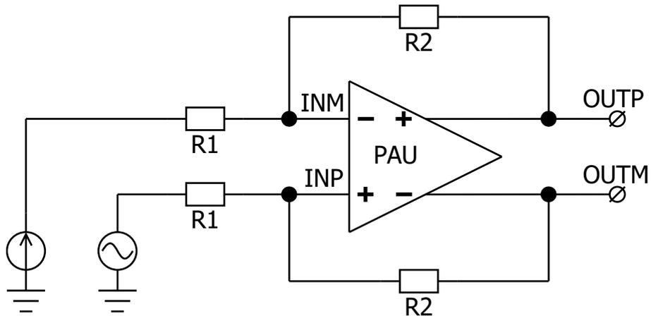
Рисунок 7. Функциональная схема дифференциального усилителя.
