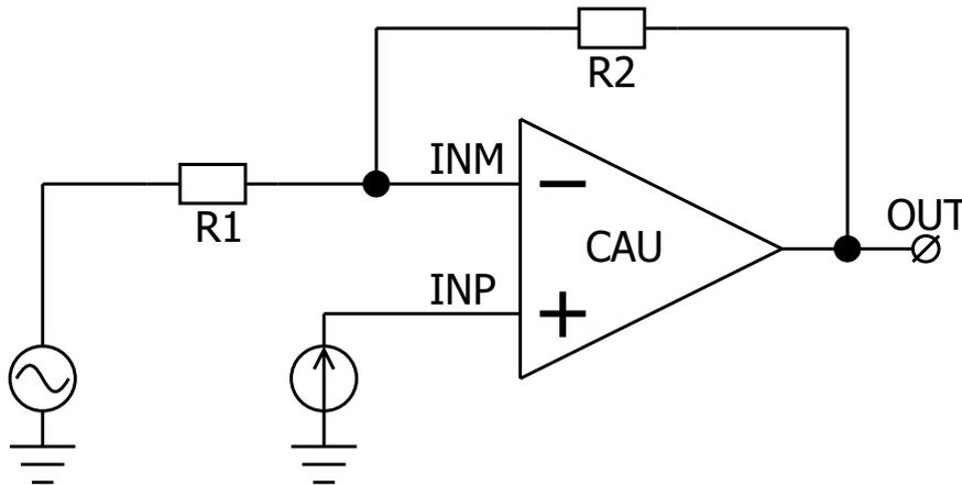
Рисунок 5. Функциональная схема инвертирующего усилителя.
