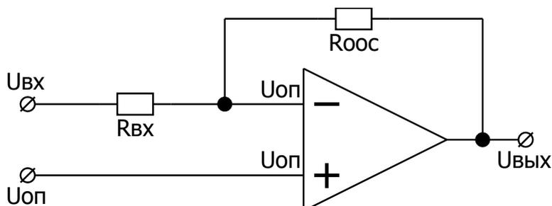
Рисунок 2. Схема включения инвертирующего усилителя.
