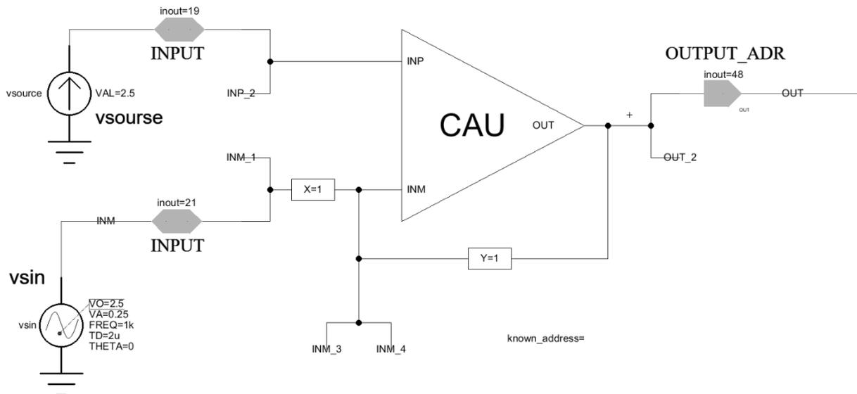
Рисунок 6. Схема инвертирующего усилителя в ПО DCSElectric.
