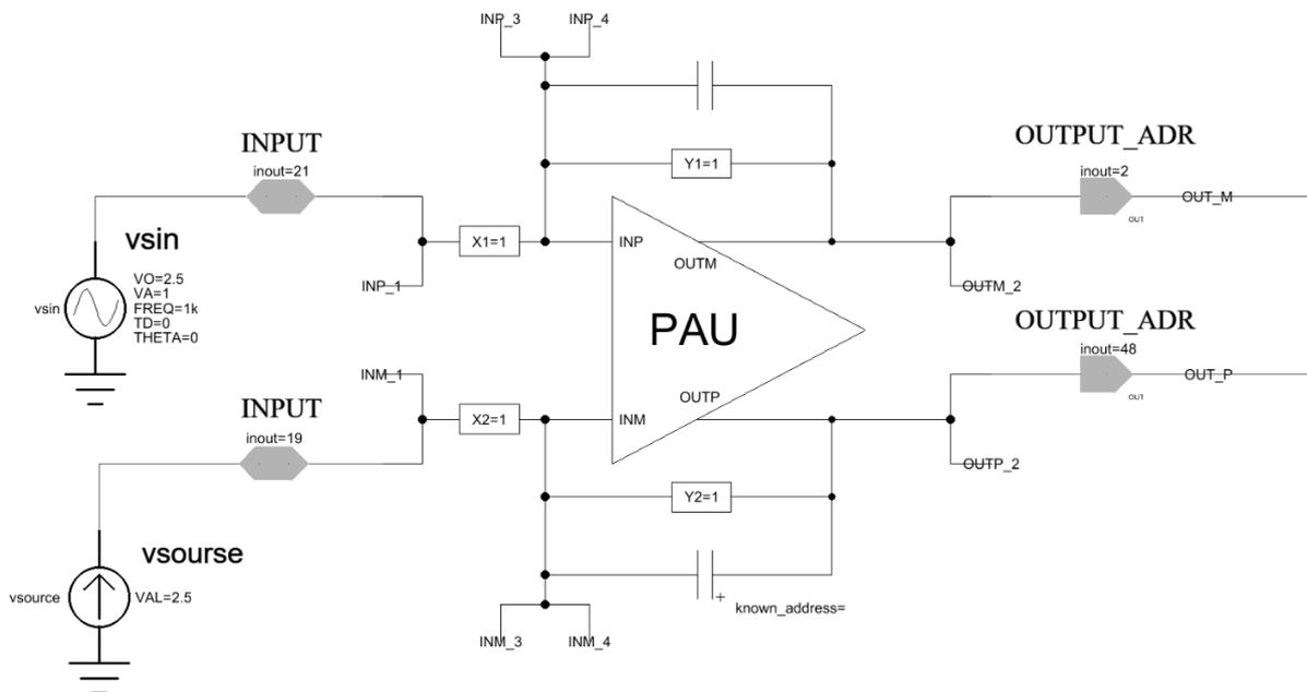
Рисунок 8. Схема дифференциального усилителя в ПО DCSElectric.
