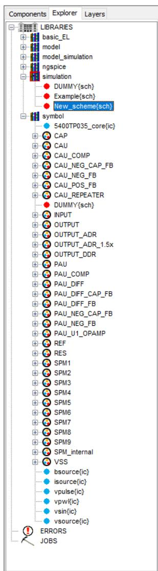
Рисунок 9. Расположение блоков библиотеки symbol в программе «DCSElectric».
