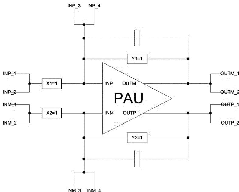
Рисунок 12. Полностью дифференциальный ОУ 2-го типа с отрицательной обратной связью.
