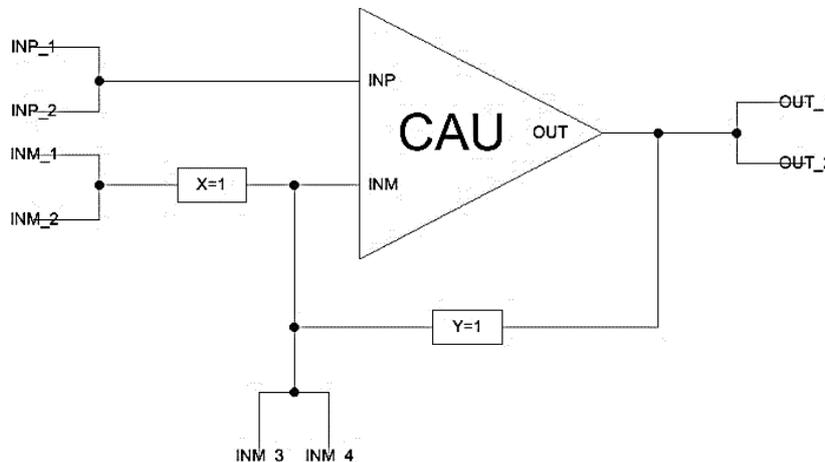
Рисунок 10. ОУ 1-го типа с отрицательной обратной связью.
