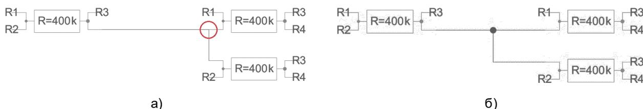
Рисунок 13. а) пример неправильного построения схемы; б) пример правильного построения схемы.
