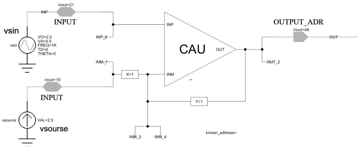
Рисунок 4. Схема неинвертирующего усилителя в ПО DCSElectric.
