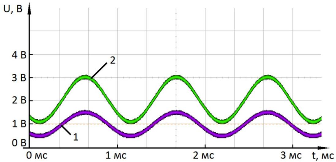
Рисунок 5. Экспериментальный результат реализации неинвертирующего усилителя, собранного по схеме Рисунок 4.
