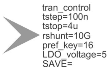
Рисунок 16. блок параметров моделирования 5400TP035\_core
