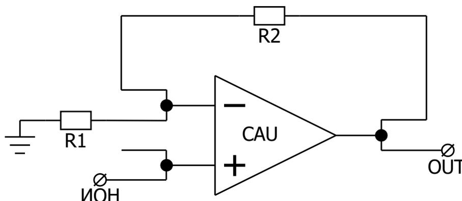
Рисунок 6. Функциональная схема неинвертирующего усилителя.
