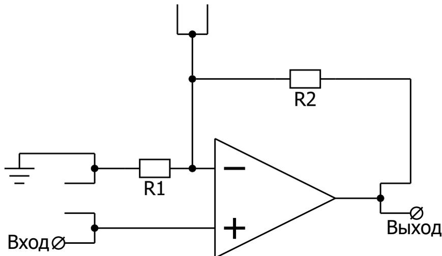
Рисунок 2. Реализация неинвертирующего усилителя (вариант 1).
