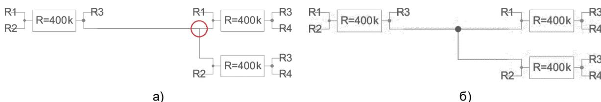
Рисунок 15. а) пример неправильного построения схемы; б) пример правильного построения схемы.
