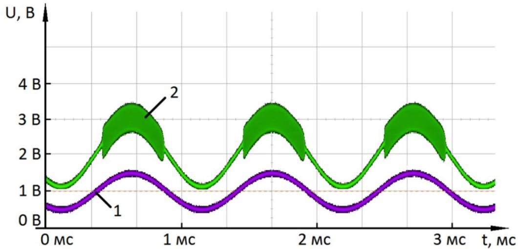
Рисунок 3. Экспериментальный результат реализации неинвертирующего усилителя, собранного по схеме Рисунок 2.
