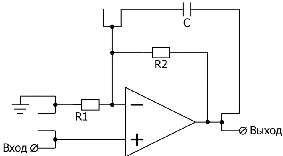
Рисунок 4. Реализация неинвертирующего усилителя (вариант 2).
