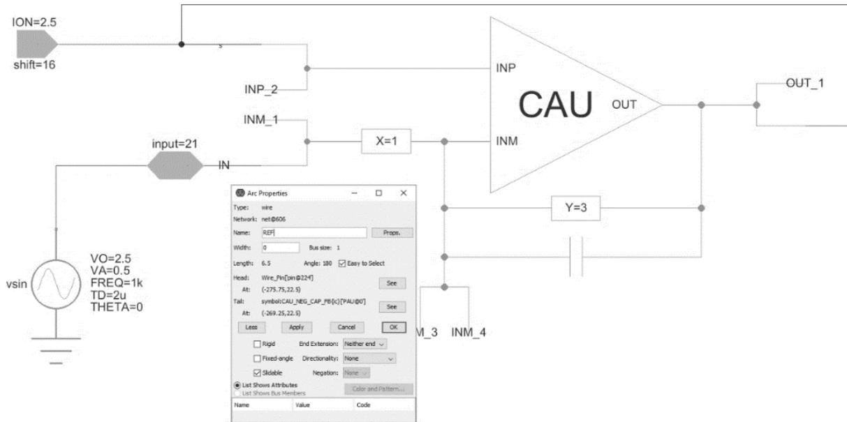
Рисунок 18. Обозначение выводов после построения схемы
