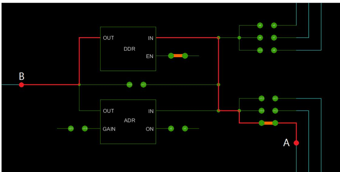
Рисунок 66. Соединение точки А с точкой В через цифровой буфер
