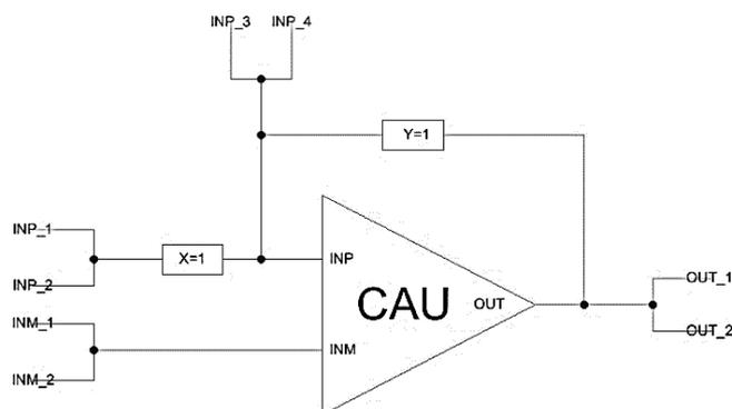
Рисунок 11. Графическое отображение элемента CAU\_POS\_FB
