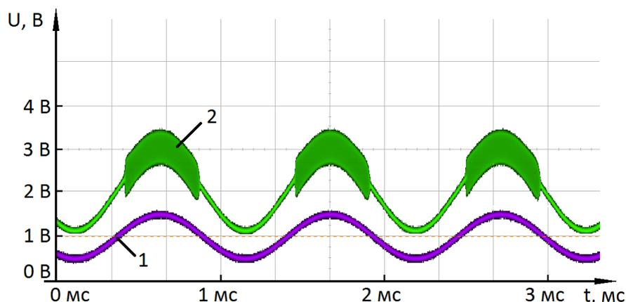
Рисунок 77. Экспериментальный результат реализации неинвертирующего усилителя (вариант 1)
