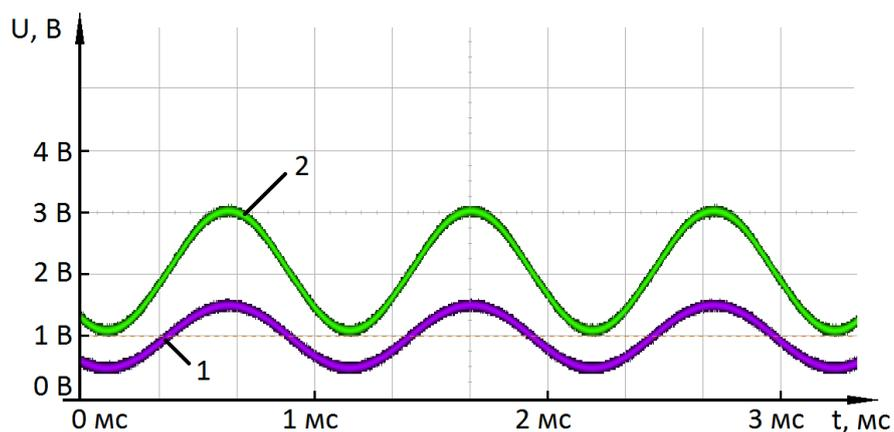
Рисунок 79. Экспериментальный результат реализации неинвертирующего усилителя (вариант 2)
