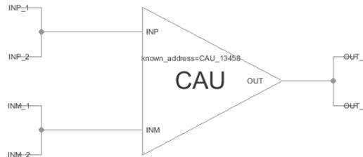
Рисунок 42. Указание адреса блока для автоматической трассировки
