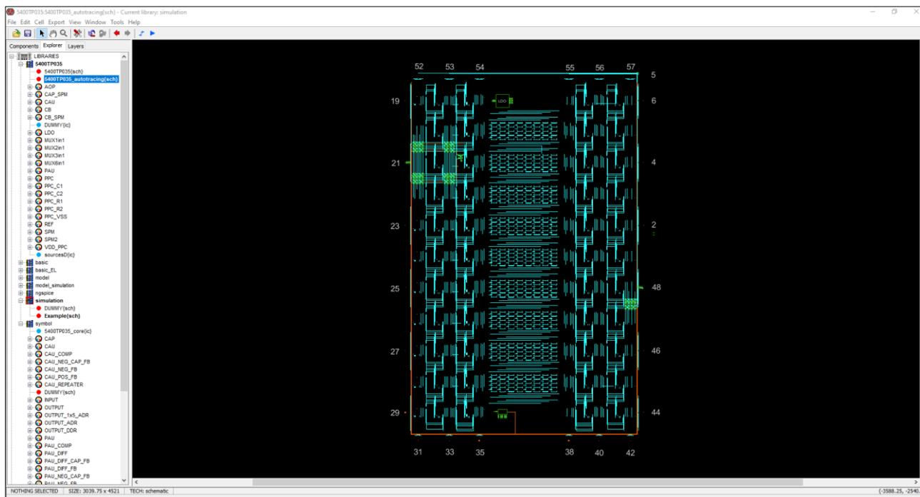
Рисунок 39. Результат автоматической трассировки
