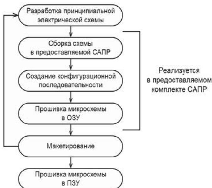
Рисунок 3. Маршрут проектирования программируемых схем
