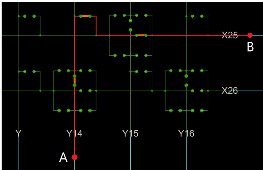
Рисунок 65. Соединение точки А с точкой В в блоке коммутации
