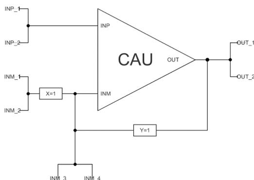
Рисунок 10. Графическое отображение элемента CAU\_NEG\_FB
