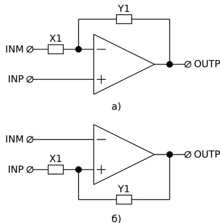
Рисунок 57. Эквивалентная схема потенциометров в усилительном блоке:
