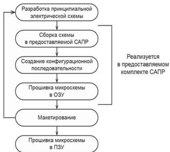
Рисунок 4. Маршрут проектирования программируемых схем
