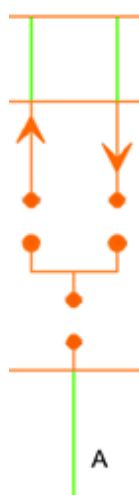
Рисунок 10. Блок, задающий направление цифрового сигнала без замкнутых ключей
