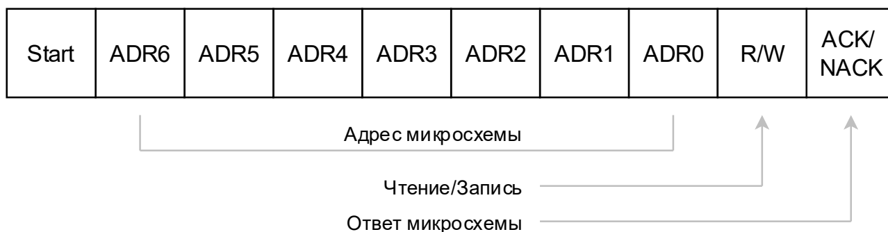
Рисунок 9. Структура передачи пакета данных от master
