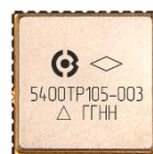
Рисунок 2. Внешний вид микросхемы 5400TP105-003
