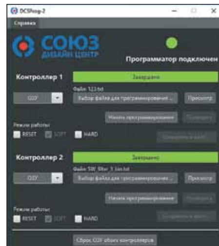
Рис. 6. Специализированное ПО для загрузки данных в память микросхемы
