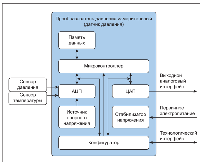
Рис. 5. Структурная схема реализованного блока электронного датчика давления
