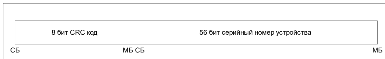
Рисунок 20. 64-х разрядный адрес микросхемы (МБ – младший бит, СБ – старший бит).
