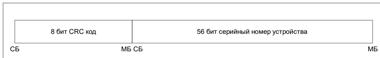
Рисунок 15. 64-х разрядный адрес микросхемы (МБ – младший бит, СБ – старший бит).
