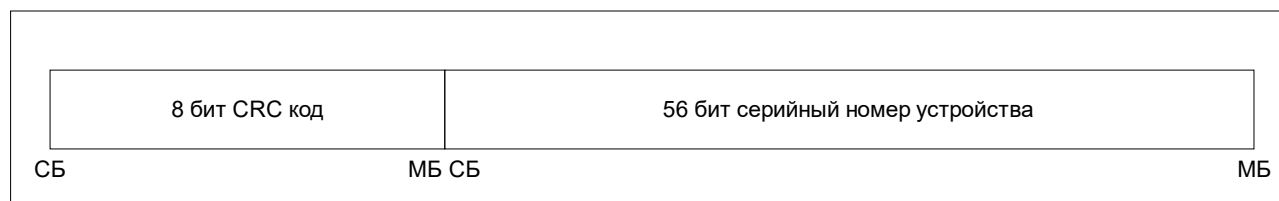
Рисунок 8. 64-х разрядный адрес микросхемы (МБ – младший бит, СБ – старший бит).
